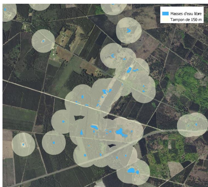
Figure 20. Visualisation des masses d'eau libre connectées entre elles à partir d'une bande tampon de 150 m
